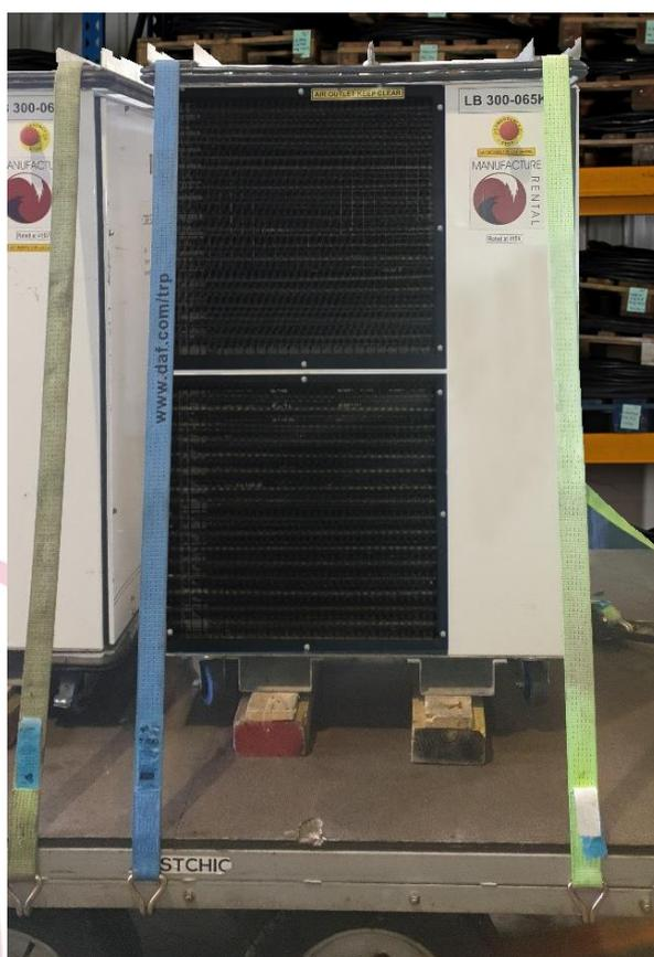
Figure 7 – Sanglage de bancs de charge sur roulettes
